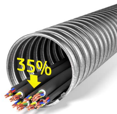
Заполняемость металлорукава согласно ПУЭ Раздел 2 (п. 2.1.61) не более 35%.
