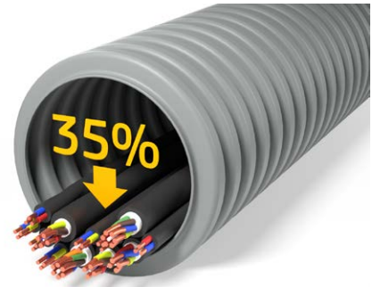
Заполняемость гофрированной трубы согласно ПУЭ Раздел 2 (п. 2.1.61) не более 35%.
