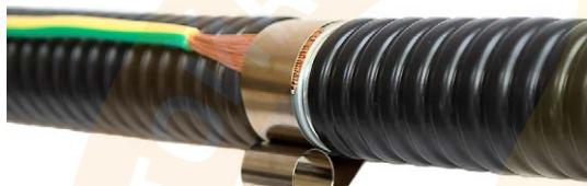
Прижать провод заземления одним витком пружины так, чтобы нижний край пружины находился на расстоянии не более 5 мм от среза изоляции.
