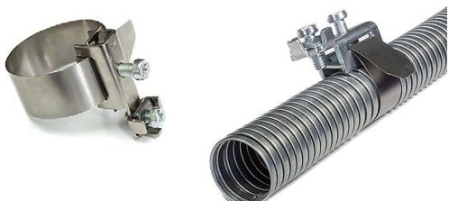
При отсутствии возможности установки заземляющего устройства на вводную муфту ВМ или ВМУ, заземление металлического рукава выполняется с помощью хомута заземления Промрукав. Это устройство заземления возможно установить в любом наиболее удобном месте. Хомут устанавливается на металлический рукав и с помощью винтового зажима, зажимается на нем.
