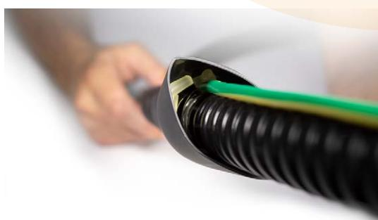
В образовавшуюся воронку всыпать термоплавкий клей и равномерно распределить его в манжете.
