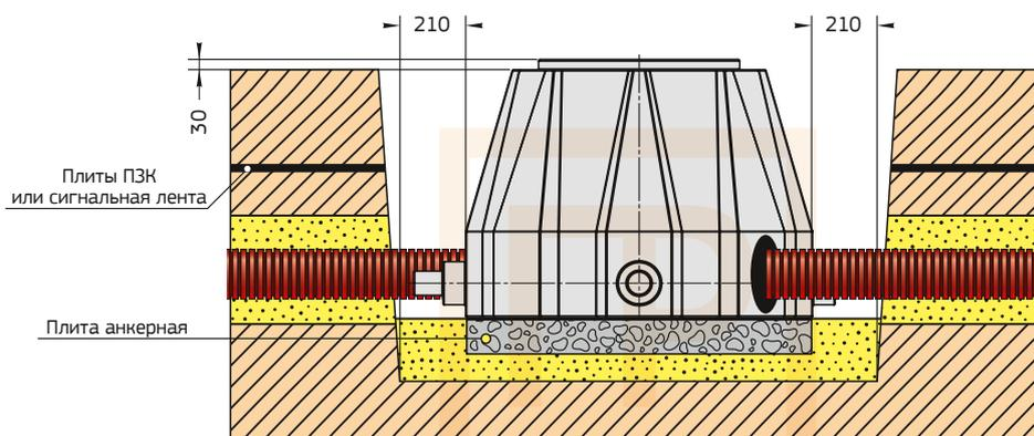
Рисунок №13. Установка вне проезжей части
