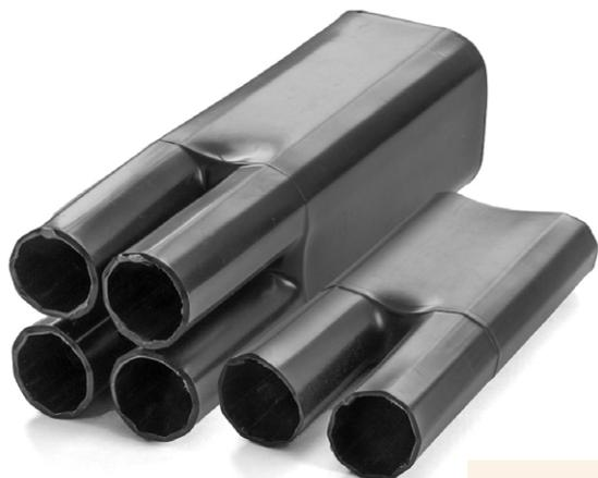
Термоусаживаемые перчатки предназначены для герметизации и изоляции корней разделки многожильных силовых кабелей с бумажной маслопропитанной, пластмассовой и резиновой изоляцией. Используются при вводе кабеля в электрошкафы и щитки, а так же для соединения двух кабелей с аналогичными размерами и характеристиками.
