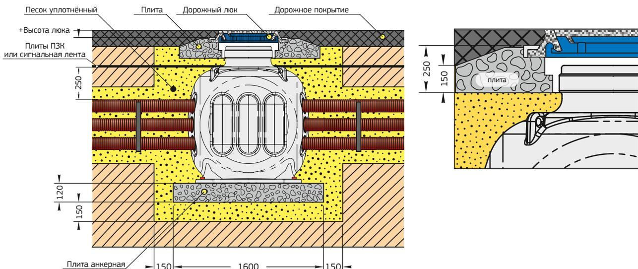
Рисунок №18. Установка под проезжую часть
