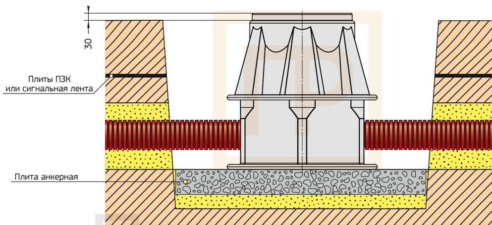
Рисунок №11. Установка вне проезжей части
